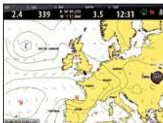
La capacità di vedere i dati aggiornati delle previsioni costituisce un grande vantaggio per comprendere quali saranno le condizioni meteorologiche. È possibile visualizzare la velocità e la direzione del vento e la pressione barometrica e animarle per mostrare gli sviluppi delle condizioni meteo. I file GRIB possono essere facilmente caricati attraverso la porta USB.
