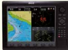
Zeus può essere utilizzato sia come display di Pilota sia come unità di controllo, senza la necessità di un controller o di un display indipendente separato. Una pressione del pulsante pilota abilita lo schermo Pilota e le opzioni di controllo.
