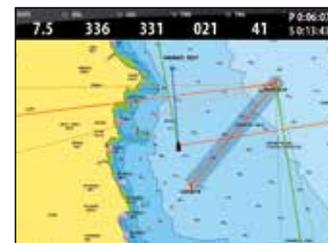
I più importanti dati per la vela sono sovrapposti sullo schermo della carta, consentendo una valutazione realistica della rotta che deve essere percorsa. I dati di navigazione sono calcolati tramite le layline, piuttosto che con una semplice linea retta di una rotta da waypoint a waypoint, che è seguita raramente dai naviganti.
