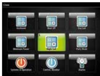
Trasformate la vostra imbarcazione a vela in una "barca intelligente" utilizzando i sistemi di navigazione a vela Zeus di B&G collegati con la commutazione digitale CZone e la tecnologia di monitoraggio. Gestite circuiti multipli dal vostro chartplotter, impostate allarmi di sistema personalizzati, monitorate i serbatoi ed impostate le modalità one-touch per la navigazione di notte/giorno e in ancoraggio. Facili da installare utilizzando una rete principale standardizzata NMEA2000®
