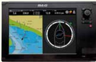
Zeus Touch è dotato di una funzionalità pilota integrata, che consente il controllo completo del pilota automatico grazie ad un semplice tocco. Montato sul timone, sarebbe perfetto come unità di controllo indipendente o potrebbe essere parte di un sistema di rete più grande.
