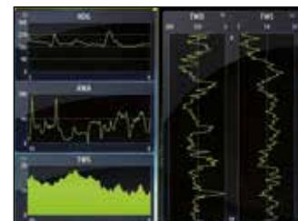
Il navigator Zeus è in grado di valutare le condizioni correnti e gli andamenti integrando tutti i dati di strumentazione disponibili. TimePlot mostra l'analisi dei dati selezionati nel tempo e WindPlot fornisce la velocità reale del vento e il tracciamento della direzione, per consentire ai naviganti di prendere le giuste decisioni mentre sono in viaggio. Zeus può inoltre visualizzare dati dal sistema di strumentazione.
